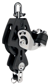
Violinblock mit Drehschäkel, Unterbügel und Schotklemme
