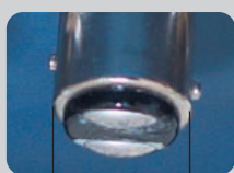
15 mm 2-polig, Fixierzapfen versetzt
