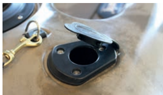
Versenkte Rutenhalter mit Dichtung
