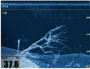
DOWN IMAGING bis ca. 120m Tiefe bis 455 kHz
